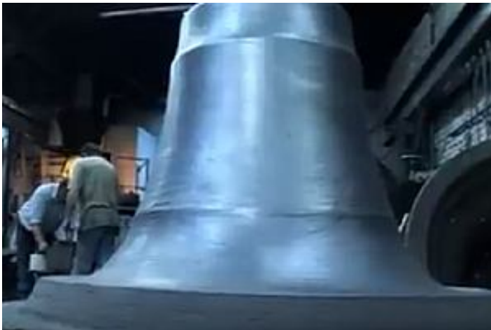
Het kleimengsel van de kern wordt glad gestreken, met grafiet behandeld en gebakken. Daarna wordt de buitenmantel met het kleimengsel gemaakt.
