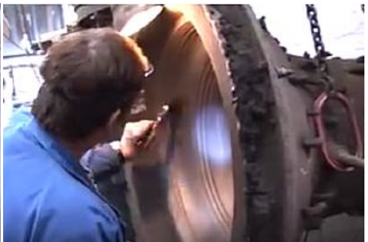
Het kleimengsel van de kern wordt glad gestreken, met grafiet behandeld en gebakken. Daarna wordt de buitenmantel met het kleimengsel gemaakt.
