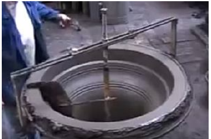
Het kleimengsel van de kern wordt glad gestreken, met grafiet behandeld en gebakken. Daarna wordt de buitenmantel met het kleimengsel gemaakt.
