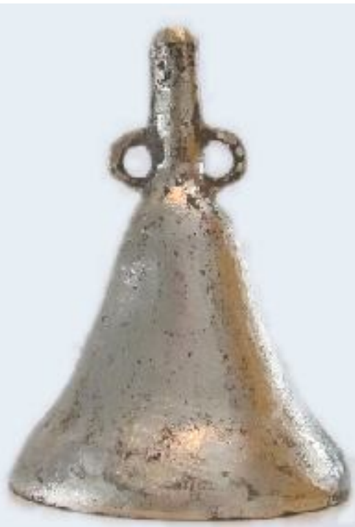
Het klokje wordt schoongespoten en gezandstraald. Rechts het klokje na een eerste schuring. Het bedevaartsklokje is gegoten met klokkenbrons, dat een legering is van 80% koper en 20% tin.
