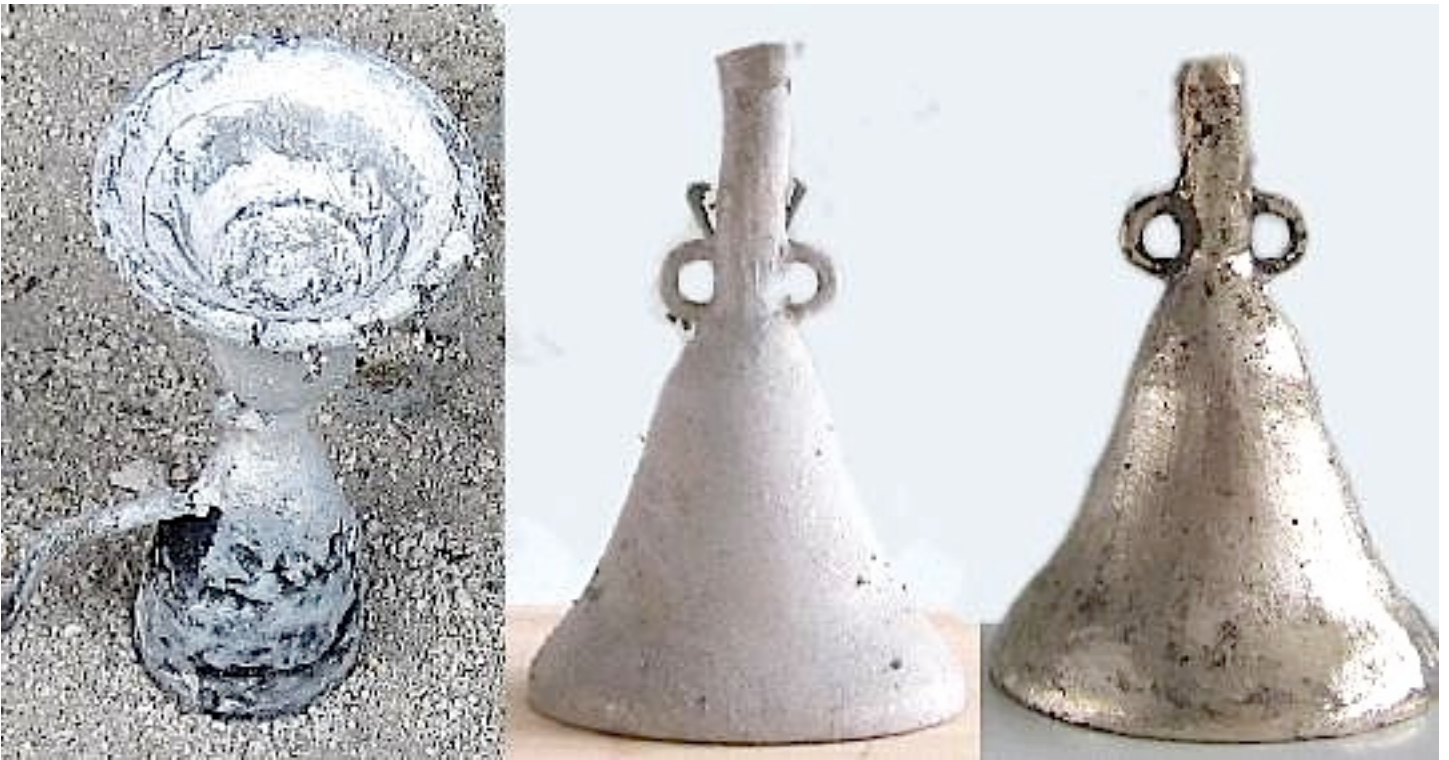
Het klokje wordt schoongespoten en gezandstraald. Rechts het klokje na een eerste schuring. Het bedevaartsklokje is gegoten met klokkenbrons, dat een legering is van 80% koper en 20% tin.
