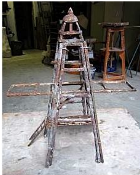
Ook de koepel kwam goed uit de gietmal. Rechts een opstelling van de klokkentoren met toebehoren. Het ciseleren, schuren, slijpen en polijsten kon beginnen.
