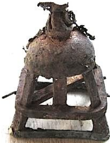
Ook de koepel kwam goed uit de gietmal. Rechts een opstelling van de klokkentoren met toebehoren. Het ciseleren, schuren, slijpen en polijsten kon beginnen.
