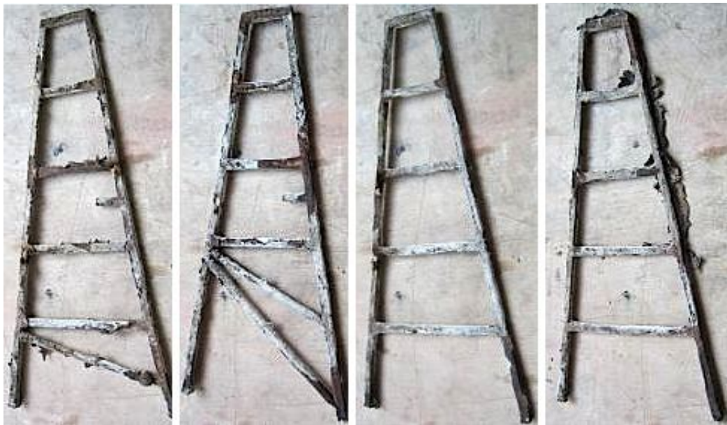
De 'ladders' werden gebruikt om nog enkele extra balkjes en slagstokje te gieten.
