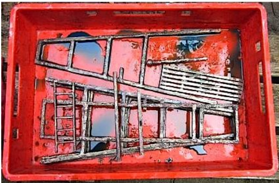
De onderdelen werden gepatineerd met kopernitraat.
