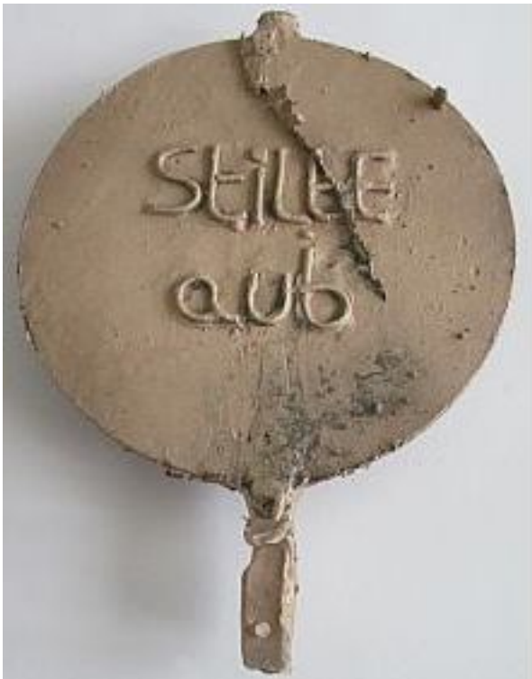
De krimpshade kan met een beitel tje worden weggetikt. Na de eerste schuurronde begint de onderzetter te blinken. De kleur is 'roder' omdat dit RG5 brons 95% koper bevat. De hoogte van het klokje is 15,5 cm, de doorsnede is 9 cm en weegt 780 gram klokkenbrons. De doorsnede van de onderzetter is 10,5 cm en het gewicht 284 gram RG5 brons.
