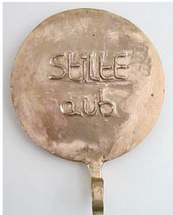
De krimpshade kan met een beitel tje worden weggetikt. Na de eerste schuurronde begint de onderzetter te blinken. De kleur is 'roder' omdat dit RG5 brons 95% koper bevat. De hoogte van het klokje is 15,5 cm, de doorsnede is 9 cm en weegt 780 gram klokkenbrons. De doorsnede van de onderzetter is 10,5 cm en het gewicht 284 gram RG5 brons.
