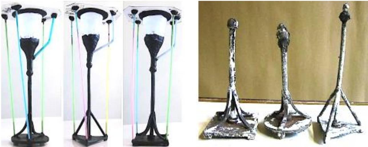
De in klokkenbrons gegoten torsos kwamen met veel beitel- en schuurwerk uit het gietproces.
