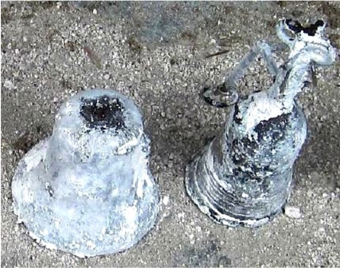
Bij het gieten met klokkenbrons is de bij de 'kroon' afgebroken.
