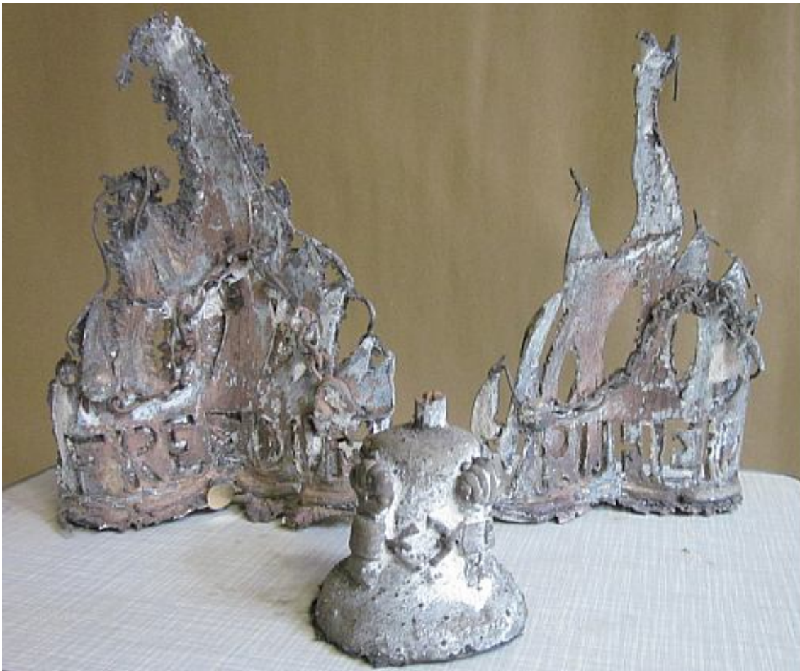
De staande wanden van vlammen met kettingen zijn gegoten in standaard RG7 brons. Het vrijheidsklokje is gegoten met klokkenbrons. Voor de wanden is het gietproces goed verlopen, maar bij het klokje is een stukje van het handvat afgebroken.
