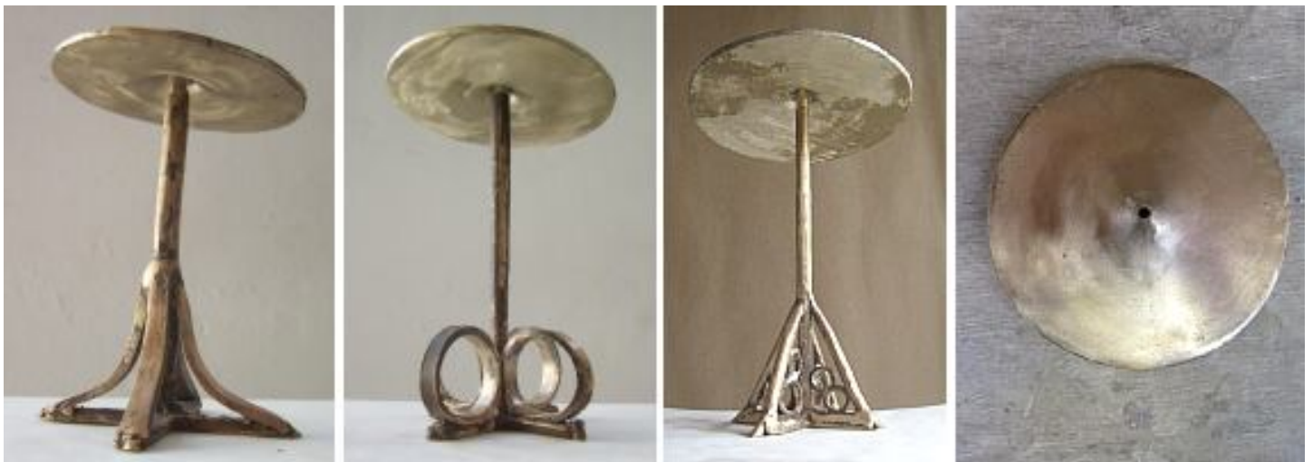
De standaards werden met gewoon RG7 brons gegoten en de bekkens met klokkenbrons.
