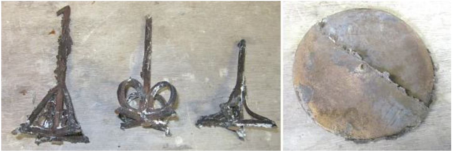
De standaards werden met gewoon RG7 brons gegoten en de bekkens met klokkenbrons.
